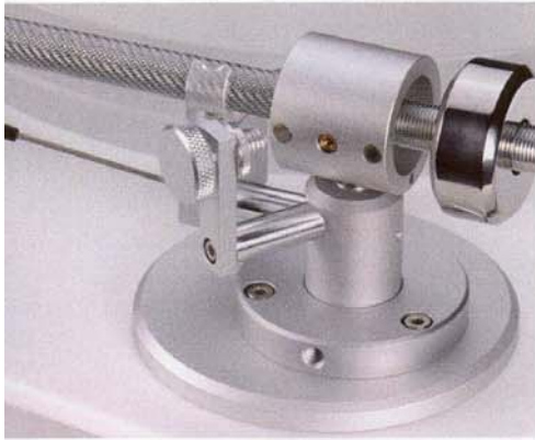
Die beiden runden Punkte links und rechts der Stellschraube am Armende sind die Magnete der Anti-Skating-Vorrichtung, die zuverlässig arbeitet
